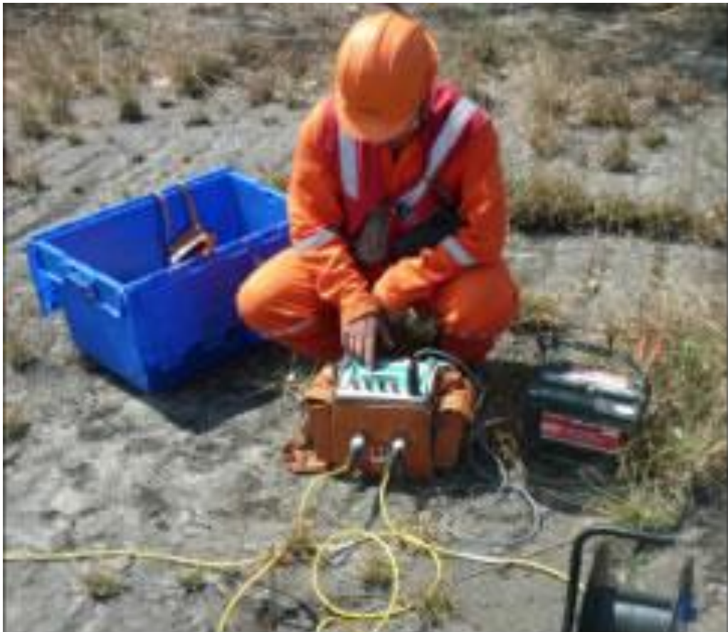
Imagen 3.1 Trabajo de campo con el equipo SYSCAL R2
